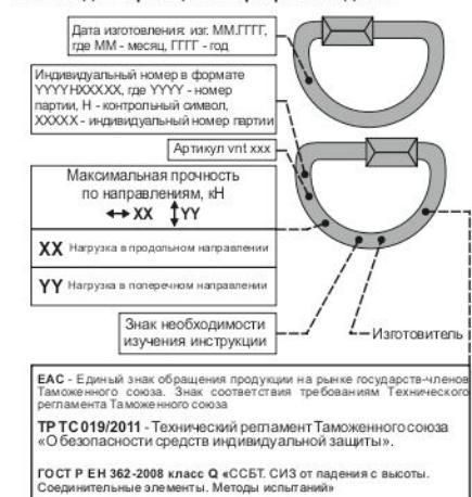
**Рис. 3. Приложение нагрузки к карабину**
