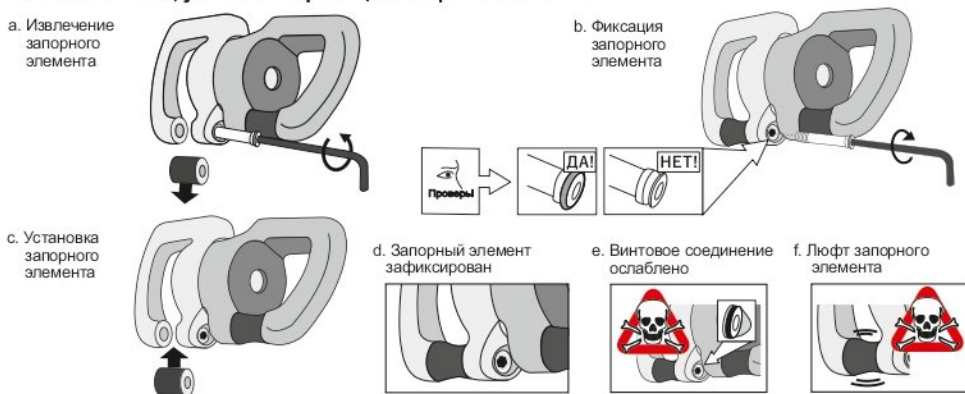
Рис. 4. Извлечение, установка и фиксация запорного элемента
